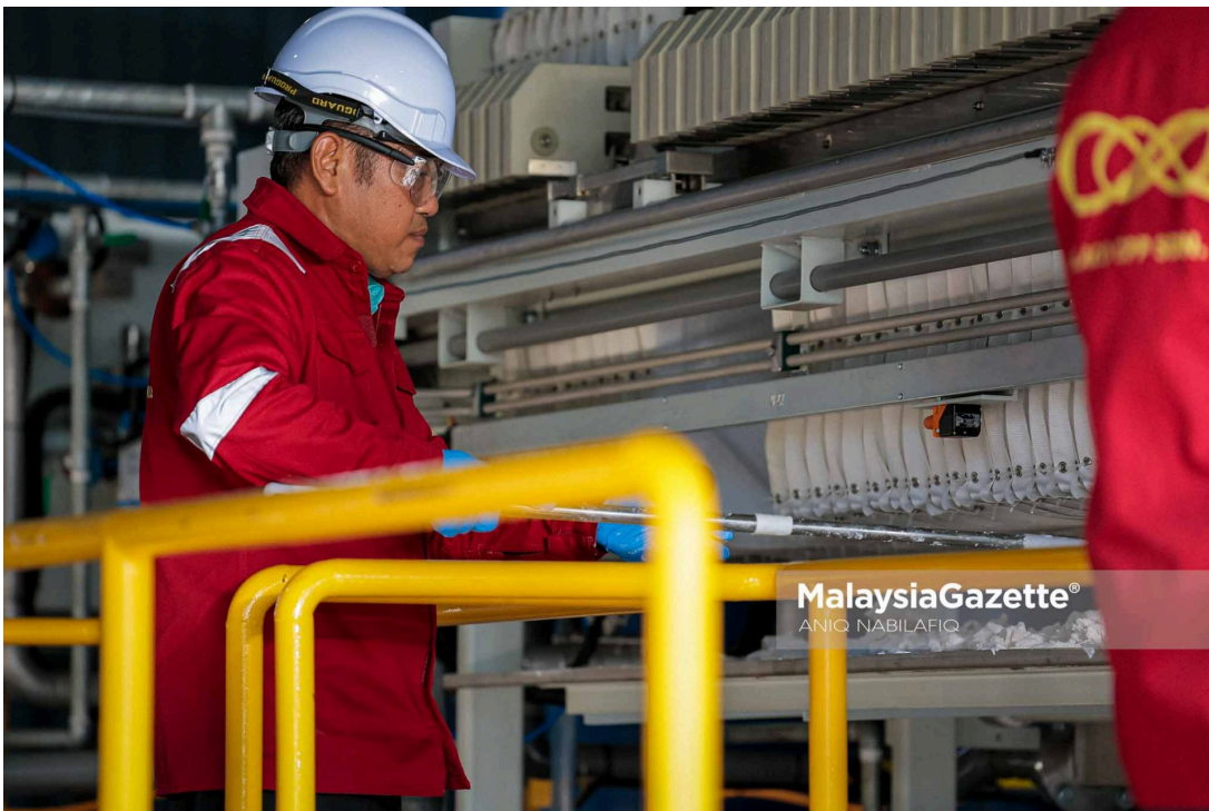
Gambar hiasan. Proses pengasingan mineral NR-REE di Kilang Malaco Mining Sdn Bhd di Kawasan Perindustrian Tungzen, Kampung Kepayang. Foto ANIQ NABILAFIQ ANUAR, 07 DISEMBER 2024.
